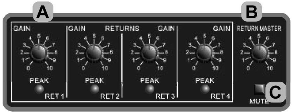
Este indicador muestra el nivel de la señal de entrada de la unidad (independientemente del nivel de salida) en los casos en que se ajusta el volumen de ganancia.
